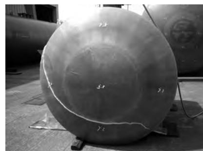
過剰圧力実験により破壊されたSF二重殻タンク。とくに鏡部の角が弱いことが確認された。
