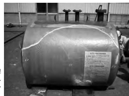
過剰圧力実験により破壊されたSF二重殻タンクの胴部
