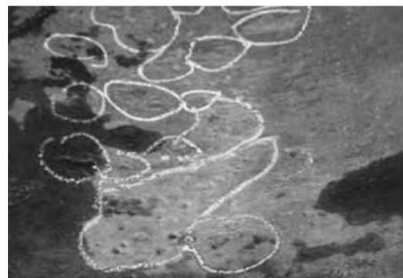
埋設後35年の地下タンク(タンク内部)
