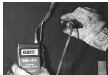
施工タンク鋼板の板厚測定
