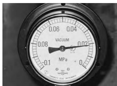
■真空計による計測（減圧試験）
